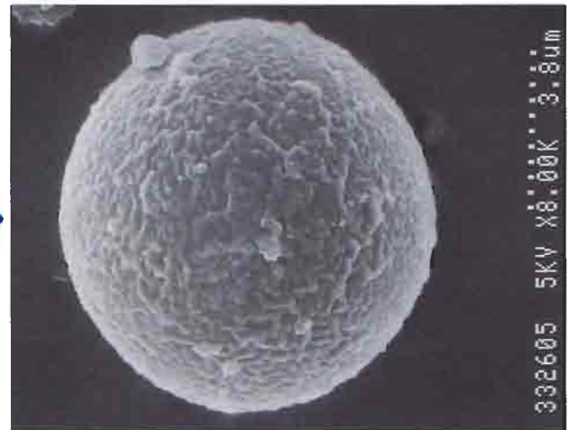
原料：母粒子=シリカ+子粒子=アクリル微粒子 平均粒子径 D_{p50}=6.0\mu\text{m} Encapsulated silica by PMMA D_{50}=6.0\mu\text{m}
