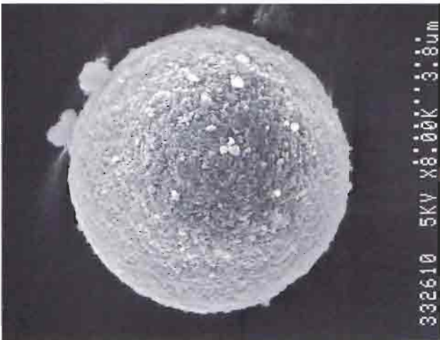
原料：母粒子=シリカ+子粒子=アクリル微粒子 平均粒子径 D_{p50}=6.0\mu\text{m} Encapsulated silica by PMMA D_{50}=6.0\mu\text{m}
