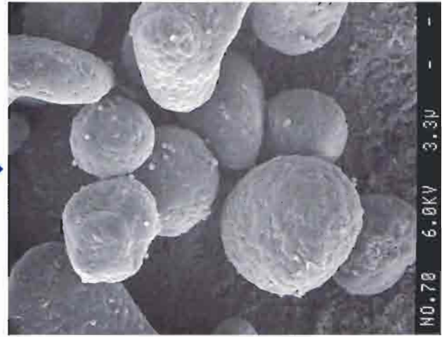
原料：母粒子=トナー+子粒子=アクリル微粒子 平均粒子径 D_{p50}=10.0\mu\text{m} Encapsulated toner by PMMA D_{50}=10\mu\text{m}
